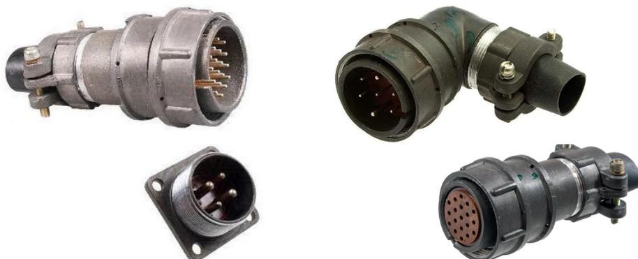
Аналоги разъемов серий 2PM/2PMT, соответствующих российским стандартам техники, широко применяющихся в отечественной радиотехнической аппаратуре. Выпускаются аналоги серий 2PM14, 2PM18, 2PM22, 2PM24. Возможна установка контактов типа "вилка" и "розетка" как в блочные, так и в кабельные части корпуса.
