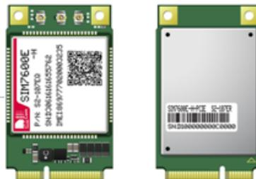
SIM7600E-H-PCIE - модуль сотовой связи LTE Cat.4 в форм-факторе PCie карты, поддерживающий стандарты LTE-TDD/LTE-FDD/HSPA+ и GSM/GPRS/EDGE и скорости обмена до 150 Мбит/сек на скачивание и до 50 Мбит/сек на выгрузку.
